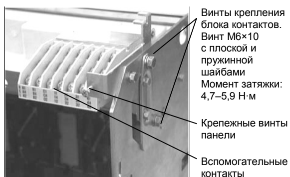
Рисунок 8. Установка опорной планки
