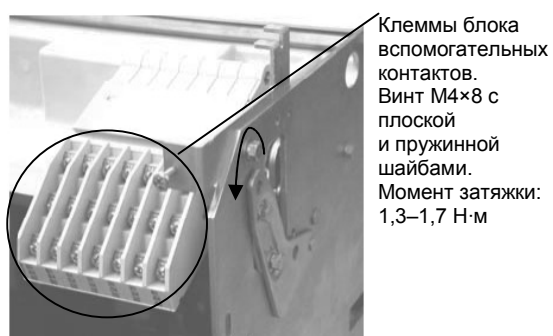
Рисунок 10. Перемещение клеммной колодки вниз
